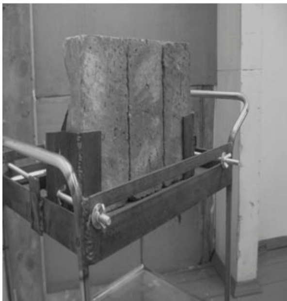
Фото 1. Установка для моделирования рикошета пули в экспериментальных условиях (с установленной и фиксированной преградой – кирпич строительный глиняный плотный марки 100)
