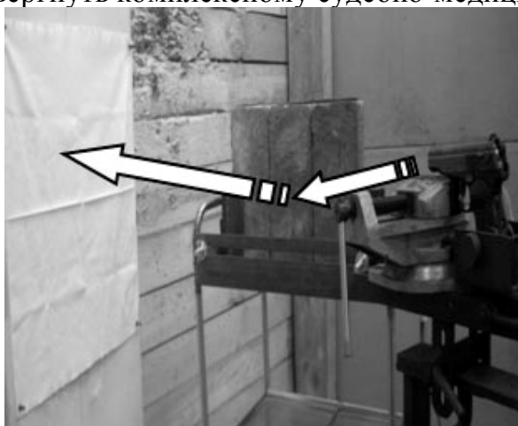
Фото 2. Взаиморасположение элементов, используемых для моделирования рикошета огнестрельного снаряда (стрелками показаны траектории полета пули до и после рикошета)
