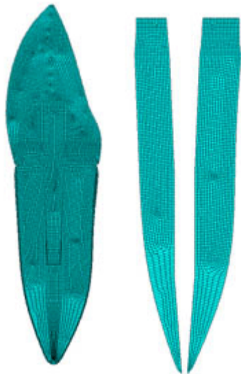
Рис. 2. Пример разбивки резца на сетку из конечных элементов: 1) всего резца; 2) дентина резца.
