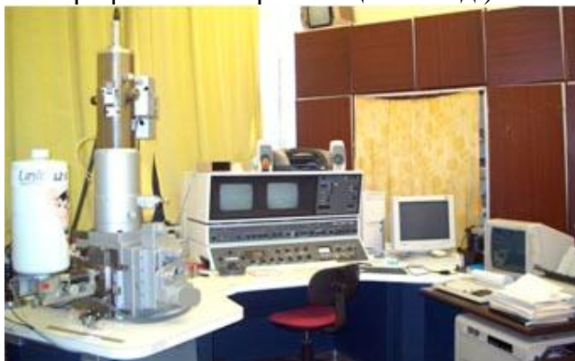
Рис.2. Сканирующий электронный микроскоп CamScan 4 с микрорентгеноспектральным анализатором AN 10000
