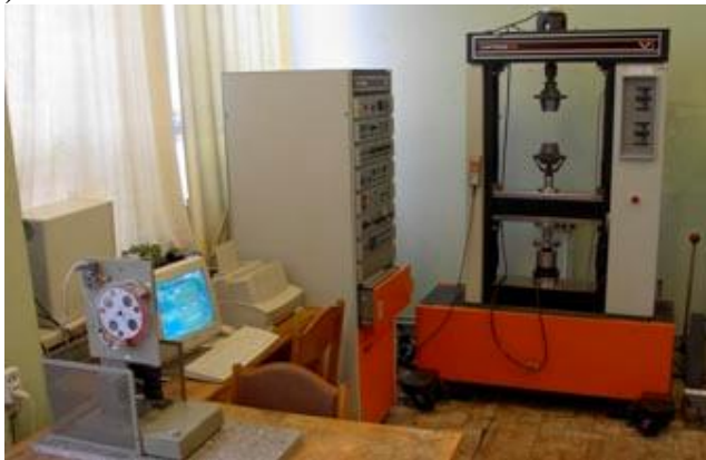
Рис.1. Комплекс механических испытаний на базе испытательной машины Instron-1195 и копра КМ-04
